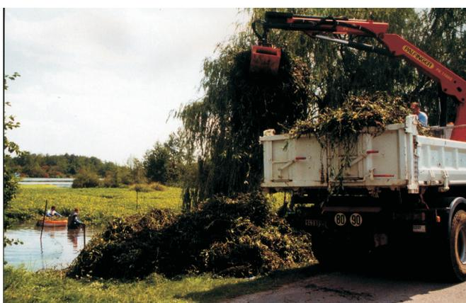
Chargement mécanique des résidus d'arrachage à bord d'un camion. Cette opération terminée, il convient de bâcher ou déployer un filet sur le chargement et d'inspecter les alentours pour récupérer les fragments dispersés.
